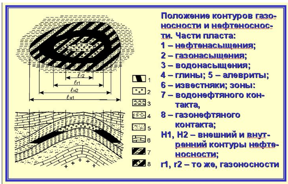
Рис. 101. Положение контуров газоносности и нефтеносности
