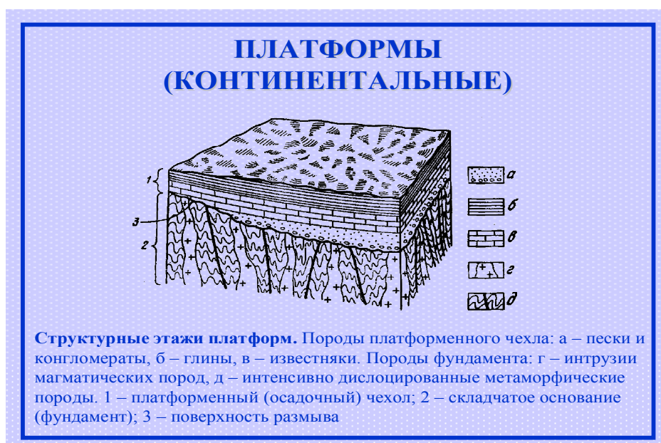
Рис. 172. Структурные этажи платформ. Породы платформенного чехла: а – пески и конгломераты, б – глины, в – известняки; породы фундамента: г – интрузии магматических пород, д – интенсивно дислоцированные метаморфические породы. 1 – платформенный (осадочный) чехол; 2 – складчатое основание (фундамент); 3 – поверхность размыва
