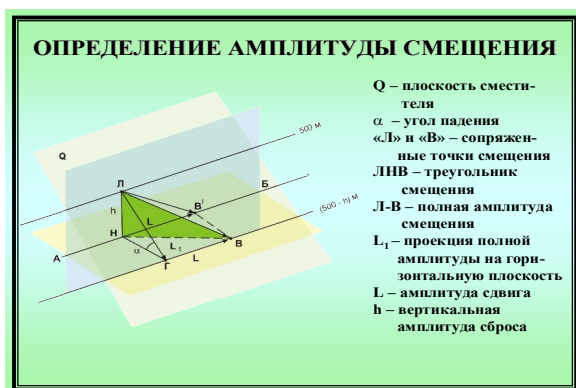
Рис. 142-1. Элементы дизъюнктива в трех плоскостях: вертикальной, горизонтальной и на плоскости сместителя (Q)
