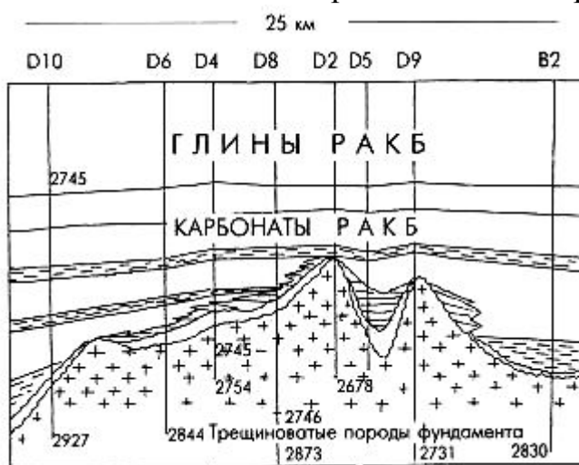
Рис. 168. Геологический разрез месторождения Ауджила-Амаль [19]
