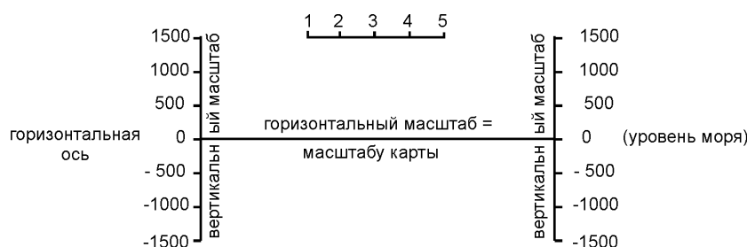
Рис. 88. Построение «рамки» геологического разреза и градуирование вертикальных осей значения точек на высоту, соответствующую отметкам горизонталей рельефа
