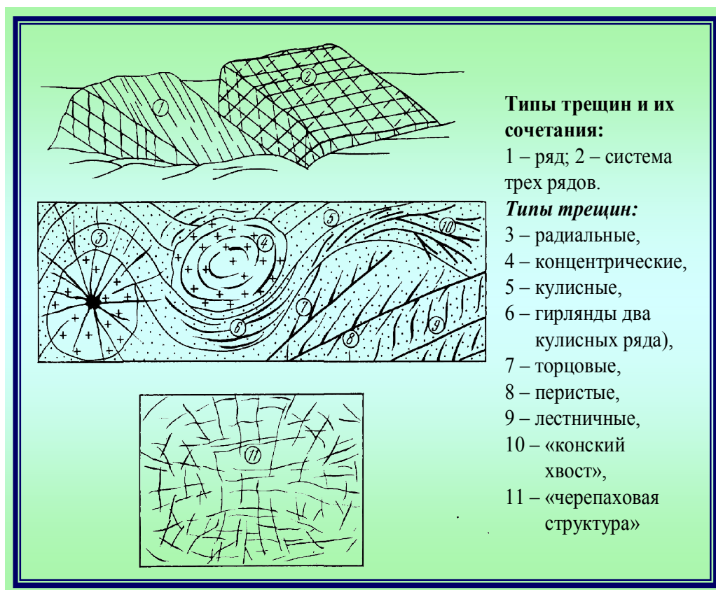
Рис. 107. Типы трещин и их сочетания
