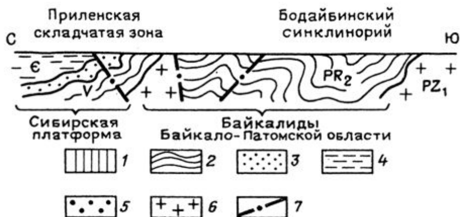
Рис. 245. Схематический тектонический разрез Байкало-Патомского нагорья, по Г.П. Леонову: 1–5 – структурно-формационные комплексы: 1 – основания, 2 – геосинклинальный, 3 – орогенный, 4 – плитный, 5 – активизации; 6 – гранитоиды различного возраста; 7 – крупные разломы
