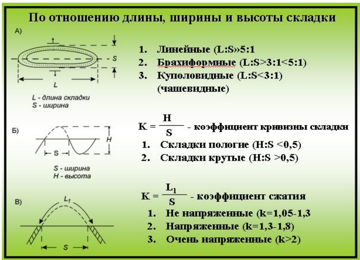
Рис. 64. Характеристика складок по отношению длины, ширины и высоты
