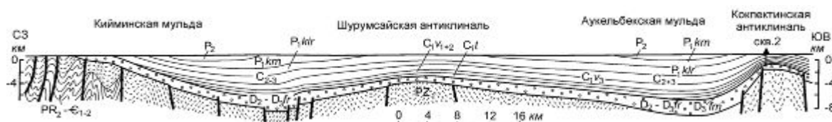
Рис. 66. Конседиментационные складки. Разрез через Тенизскую впадину, по А.Е. Михайлову [29]
