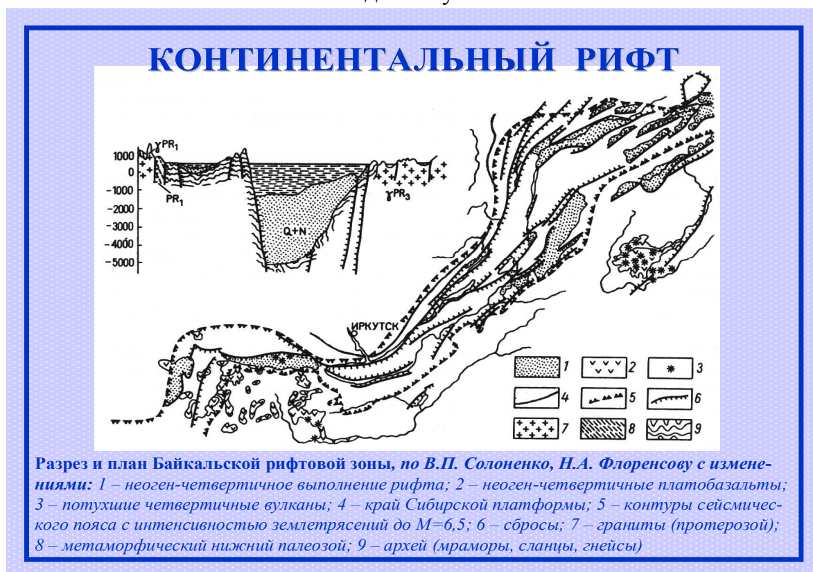
Рис. 176. Разрез и план Байкальской рифтовой зоны, по В.П. Солоненко, Н.А. Флоренсову, с изменениями [38]: 1 – неоген-четвертичное выполнение рифта; 2 – неоген-четвертичные платобазальты; 3 – потухшие четвертичные вулканы; 4 – край Сибирской платформы; 5 – контуры сейсмического пояса с интенсивностью землетрясений до M=6,5 ; 6 – сбросы; 7 – граниты (протерозой); 8 – метаморфический нижний палеозой; 9 – архей (мраморы, сланцы, гнейсы)
