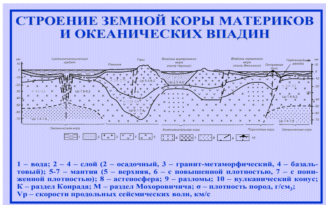
Рис. 169. Строение земной коры материков и океанических впадин [14]: 1 – вода; 2 – 4 – слой (2 – осадочный, 3 – гранит-метаморфический, 4 – базальтовый); 5–7 – мантия (5 – верхняя, 6 – с повышенной плотностью, 7 – с пониженной плотностью); 8 – астеносфера; 9 – разломы; 10 – вулканический конус; К – раздел Конрада; М – раздел Мохоровичича; \sigma – плотность пород, г/см 3 ; V_p – скорости продольных сейсмических волн, км/с
