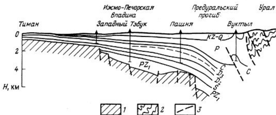
Рис. 236. Геологический разрез по профилю Урал – Тиман, по А. Я. Креме и др. 1 – фундамент; 2 – складчатая область; 3 – разломы
