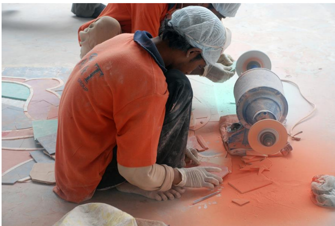
14к-расм. Флоренция мозаикаси рангли пластиналарни арралаб тайёрлаш.
