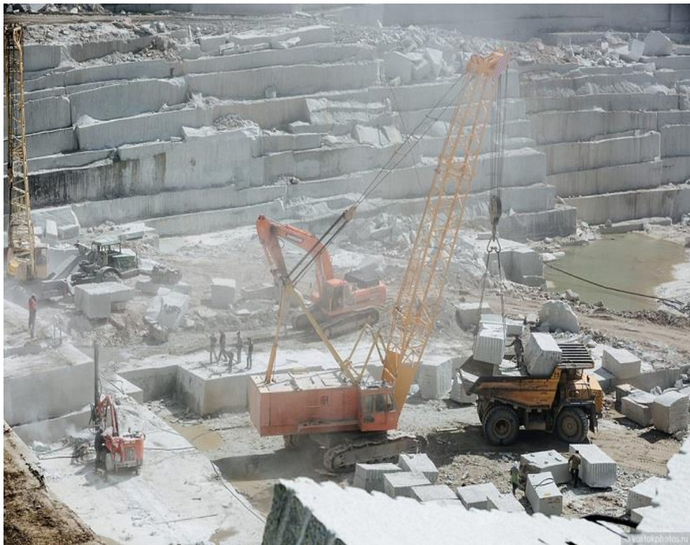
4.8- rasm. Noruda material konlarida yuklash ishlari
