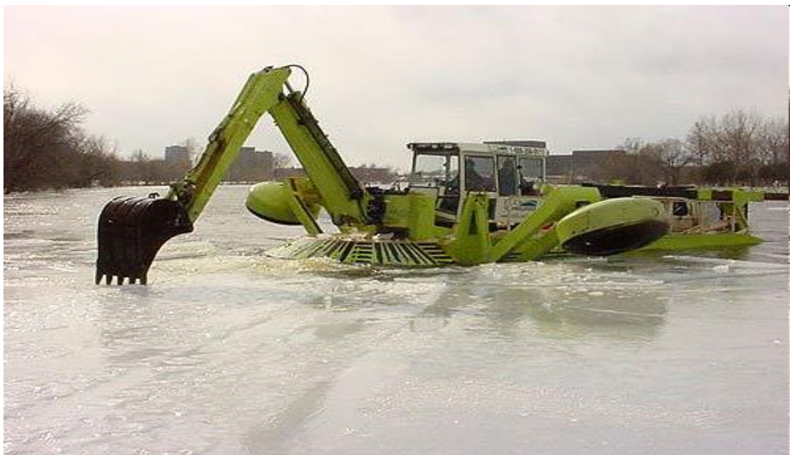
2.14-rasm. Suv havzalarini qazishga mo'ljallangan ekskavator
