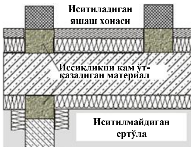
2.11 - расм. Ертўла ички девори, ертўла ёпмеси ва биринчи қават ички деворларининг ўзаро туташган жойларига иссиқликни кам ўтказадиган материал (термовкладыш) билан алмаштириб “иссиқлик кўприги” йўқотилган
