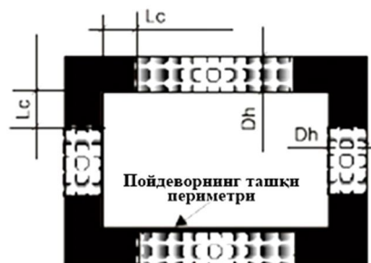
4.16-расм. Иситиладиган бинонинг пойдевори ва полидаги иссиқлик изоля-циясини ётқизишнинг схемаси ва параметрлари: 1-пойдевор; 2- девор; 3-пол; 4-горизонтал иссиқлик изоляция; 5-вертикал иссиқлик изоляция; 6-ҳимоя қопла-ма; 7-отмостка остидаги қум тўшама; 8-асфалт отмостка; 9-музламайдиган грунт; 10-дренаж; 11-полнинг иссиқлик изоляция қатлами
