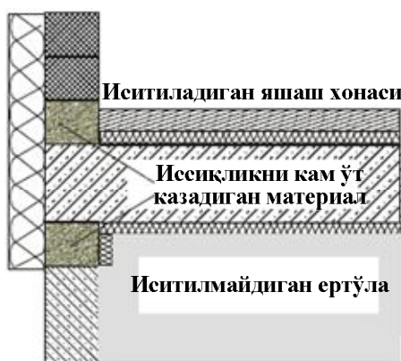
2.9-расм. Ертўла ташқи девори, ертўла ёпмаси ва биринчи қават ташқи деворларининг ўзаро туташган жойига иссиқликни кам ўтказадиган материал (термовкладыш) билан алмаштириб “иссиқлик кўприги” йўқотилган
