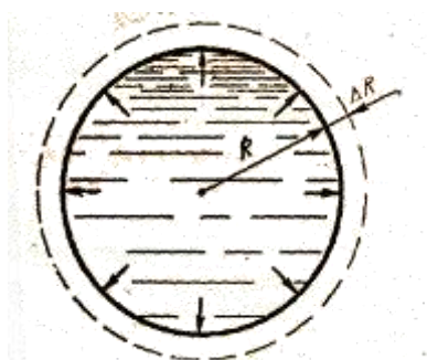
8.4 rasm. Gidravlik zarba vaqtida quvur devorining cho`zilishi
