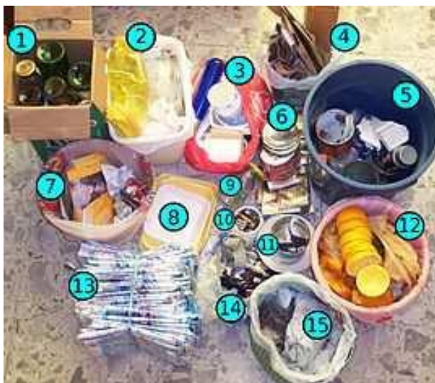
123-rasm. Ajratilgan uy chiqindilari: 1 - shisha idishlar; 2 - yupqa plastik; 3 - qalin plastik; 4 - karton; 5 - aralash chiqindi; 6 - temir bankalar; 7 - qog‘oz; 8 - polistirol; 9 - shisha; 10 – batareya-lar; 11 – metall; 12 - organik chiqindilar; 13 - «Tetrapak» o‘rama materiallari; 14 - gazlama; 15 - tualet chiqindilari
