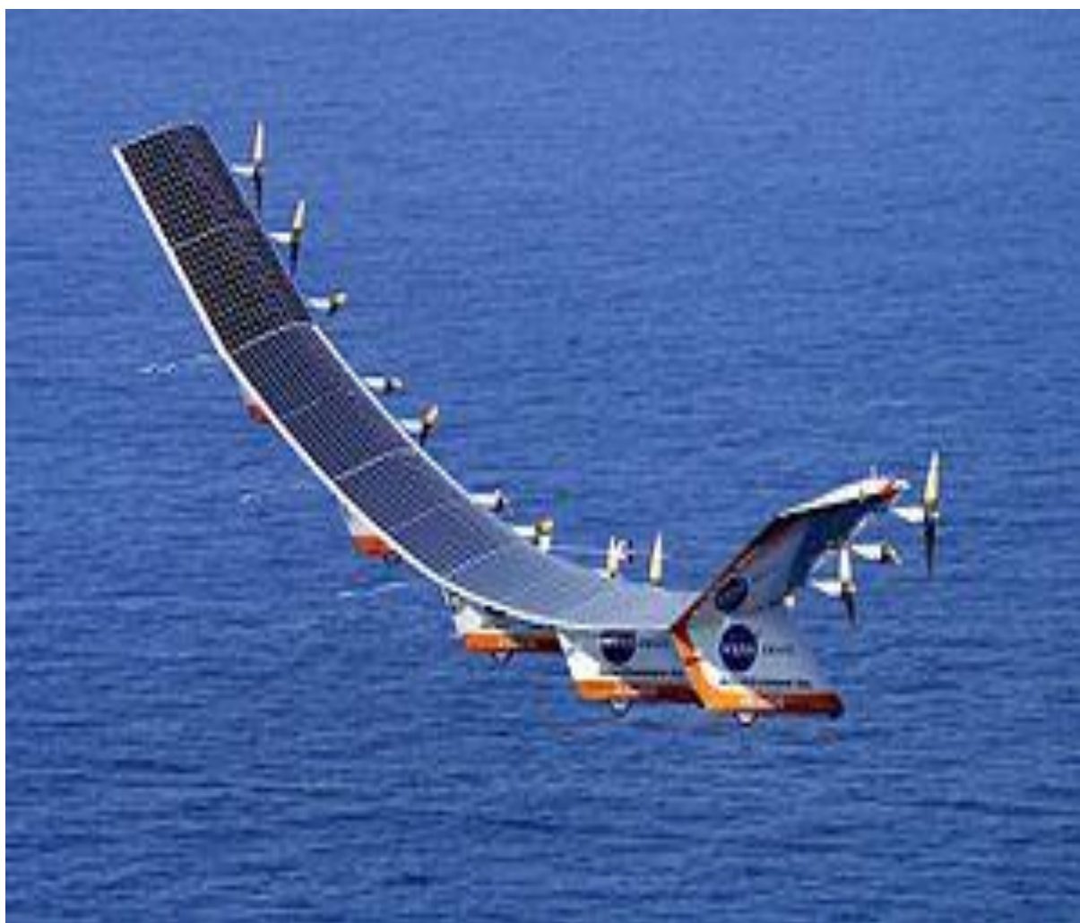
90-rasm. Quyosh energiyasidan foydalanib uchayotgan turbovintli samolyot
