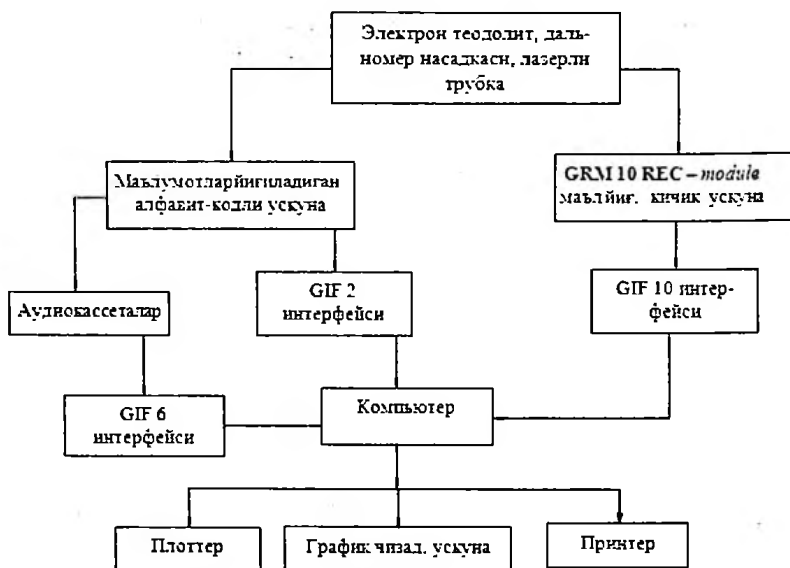
10.21-шакл. Лазерли электрон геодезик асбобларнинг ишлаш тамойили.
