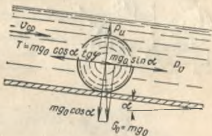
Рис. 40. Схема сил, действующих на зерно в струе воды, текущей по наклонной поверхности
