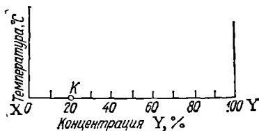
Рис. 146. Координаты для построения диаграммы состояния системы, состоящей из двух металлов.
