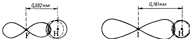
Рис. 107. Схема перекрытия электронных облаков при образовании молекул HF и HI. Пунктиром условно показано смещение электронного облака атома водорода в сторону атома галогена.
