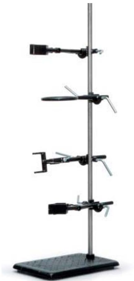
31- rasm. Laboratoriya shtativi. 1— qisqichlar; 2—tagliklar.
