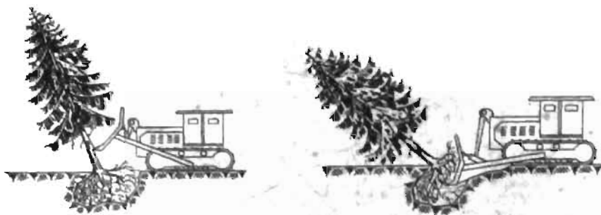
3.1.7-rasm. Daraxtlarni yiqitish tartibi:
