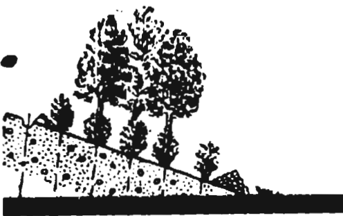
3.2.2-rasm. Qiyaligi 15^\circ bo'lgan yerlarda o'rmon daraxtlari, suv to'sar ariqlar, yaylov-pichanzorlarni joylashtirish tizimi.
