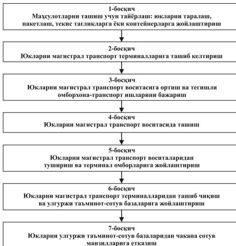
8.6 - rasm. Yuklarni yetkazib berishda transport-texnologik jarayonlarning asosiy bosqichlari.
