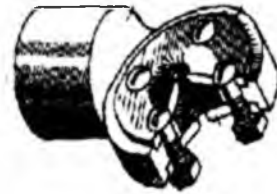
7.75-расм. Қопқоқларни конуси ташқарига қараган ҳолатда маҳкамлаш
