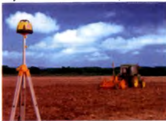
3.1-расм. ARES 697 ATZ гилдиракли трактор билан агрегатланган лазерли ер текислагич
