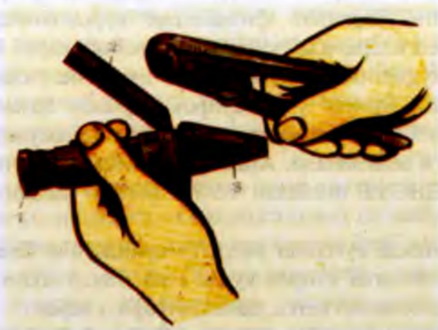
5.4-расм. Ғўза баргининг физиологик кўрсаткичлари бўйича суғориш муддатларини аниқлайдиган рефрактометр: 1-акуляр, 2-копқоқ, 3-линза.
