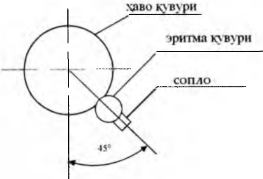
7.72-рasm. Соплони вертикалга нисбатан 45 градус бурчак остида ўрнатиш
