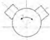
7.73-рasm. Вентилятор соплосининг тебраниш амплитудаси: \alpha=180^{\circ} - паст, \alpha=160^{\circ} - ўртача ва \alpha=140^{\circ} - баланд бўйли ғўзалар учун
