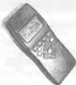
40-rasm. Nuqtaning fazoviy koordinatalarini GPS uslubida aniqlash asboblari.
