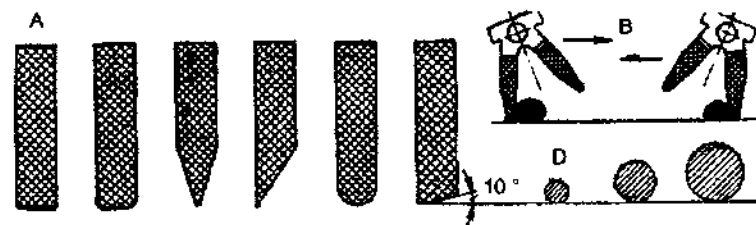
211- rasm. Turli andoza yordamida gul bosishda ishlatiladigan raklyalar: A – bir tomonlama raklya; B – ikki tomonlama raklya; D – roliksimon raklya.
