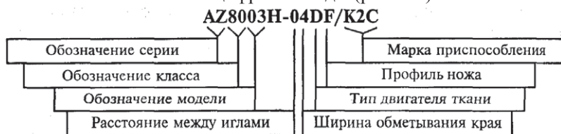
Рис. 1.4. Обозначение краеобметочных машин серии AZ800 в ее коде
