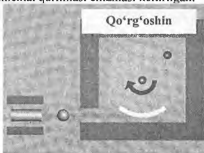
23.8-rasm. Myossbauerning eksperimental qurilmasining chizmasi.
