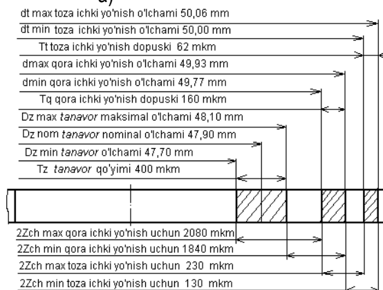
4.1-rasm. \varnothing 50_{-0,05}^{+0,062} mm li val bo'yni va diametri \varnothing 50H9 korpusli detal teshigiga ishlov berishda qo'shim va qo'shimlar joylashishining grafikaviy sxemasi: a)-valniki; b)-korpus teshiginiki
