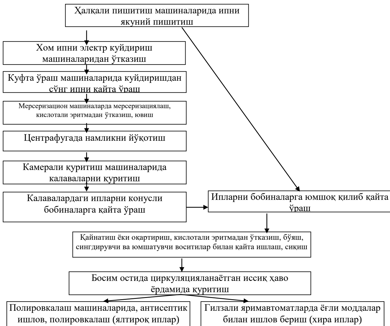
13-расм. Тикув ипларига ишлов бериш технологияси схемаси
