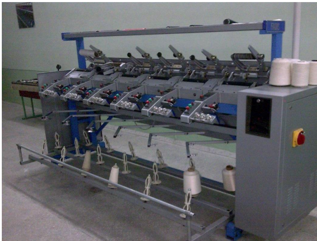
5-Расм. FADIS қўшиб ўраш машинаси.
