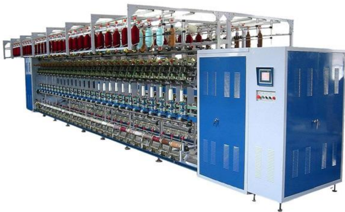
22-расм. HN 5D моделдаги шаклдор пишитувчи машина
