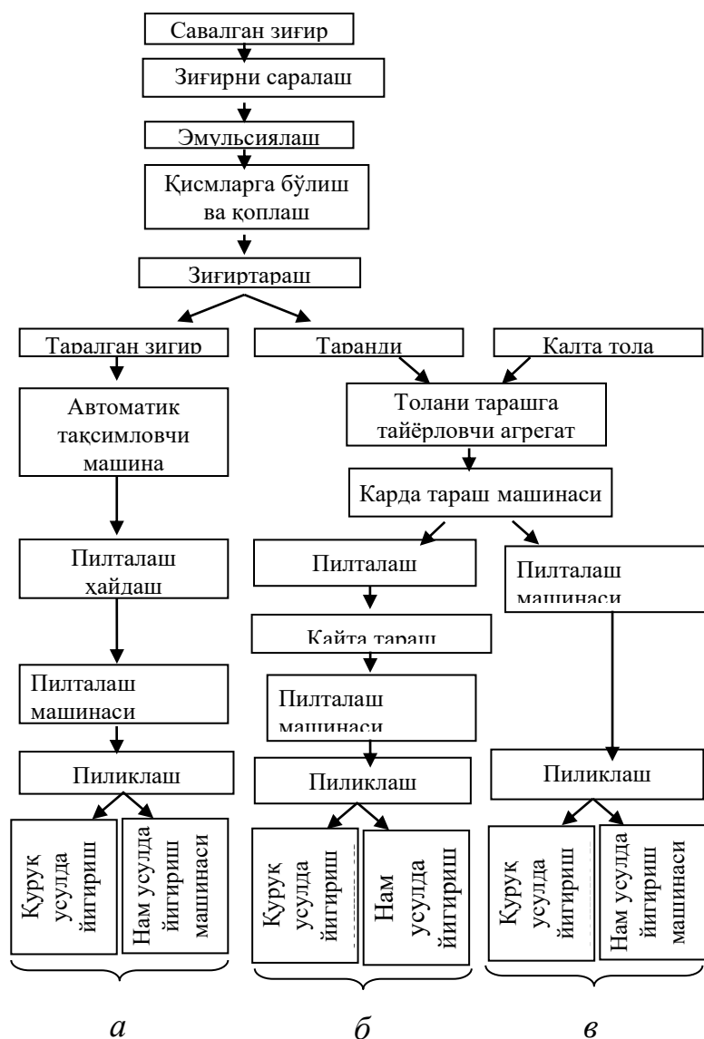
57-расм. Зиғир йиғиришнинг турли системалари а – карда тарашсиз қайта тараш; б – карда тарашли қайта тараш; в – карда
