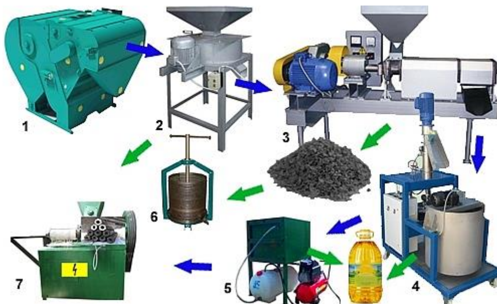
6-rasm. Presslash usulida o'simlik moylarini olish texnologik liniyasi
