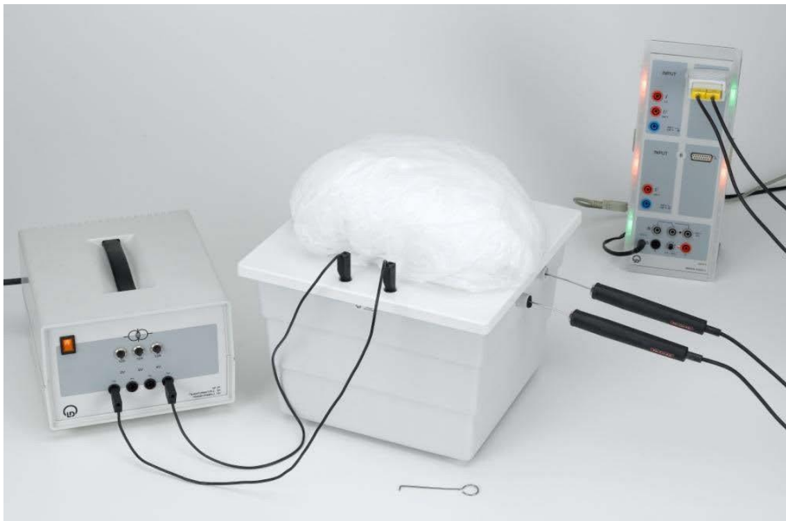
25-rasm. Yakka plastina metodidan foydalanib qurilish materiali namunasining issiqlik o'tkazuvchanligini aniqlash uchun qurilma.
