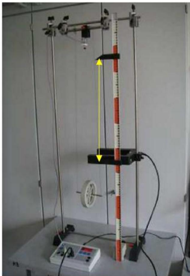
1-rasm. Maksvel disklari yordamida energiya saqlanishi qonunini tekshirish uchun mo'ljallangan tajriba qurilmasi.
