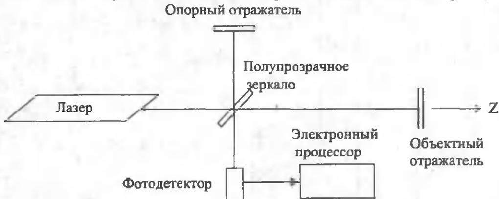
Рис.2. Интерферометрический измеритель перемещений
