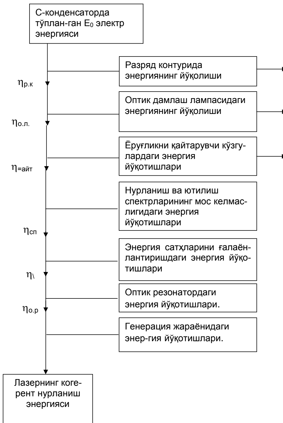
31-расм. Лазер қурилмасининг ишлашида электр энергиясининг когерент лазер нурланиш энергиясига айланишдаги энергия йўқотишларининг турлари
