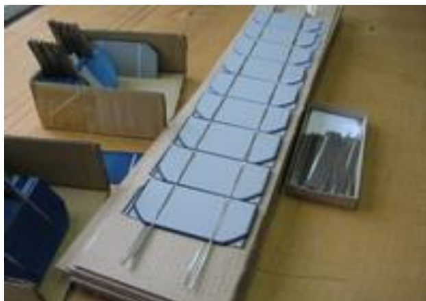
28- расм. Модулга йиғиш олдидан ҚЭ занжири
