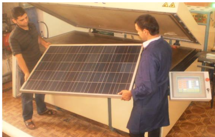
31-расм. Фотоэлектрик модул ламинация печидан сўнг
