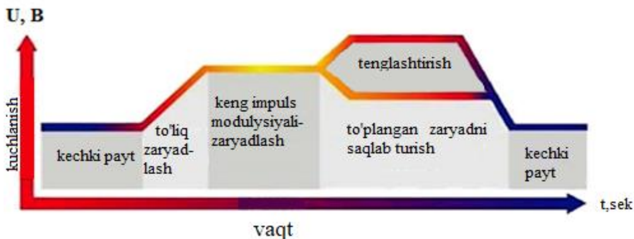
41-расм. Қуёш панелидан АБ зарядлашда босқичлар
