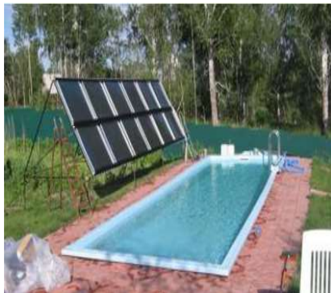
2.2.3– rasm. Quyosh kollektori yordamida basseytni isitish tizimi.
