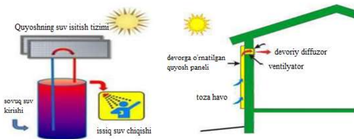
2.2.5 – rasm. Yassi Quyosh kollektorining ishlash tizimi.
