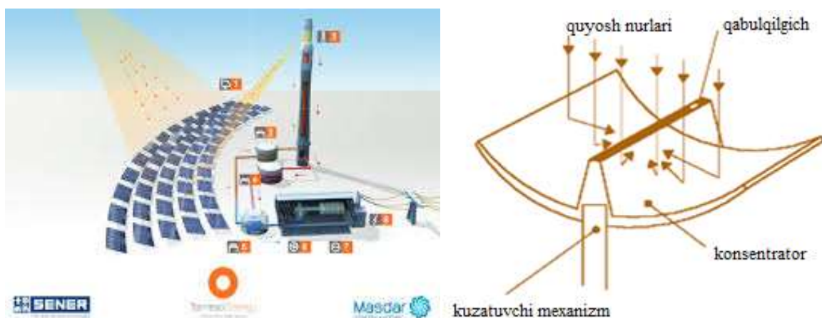
2.2.10-rasm. Parabolik quyosh elektr stantsiyasining diagrammasi.
