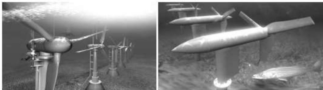
1.2.2-rasm. Dengiz oqimlarning energiyani elektr energiyaga o‘zgartiruvchi gidroenergetik qurilmalar.
