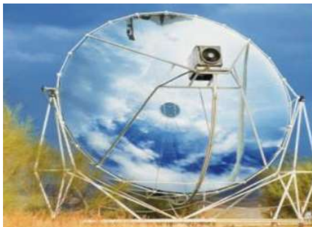
2.2.11d-rasm. Parabaoloik quyosh konsentratorlari.
