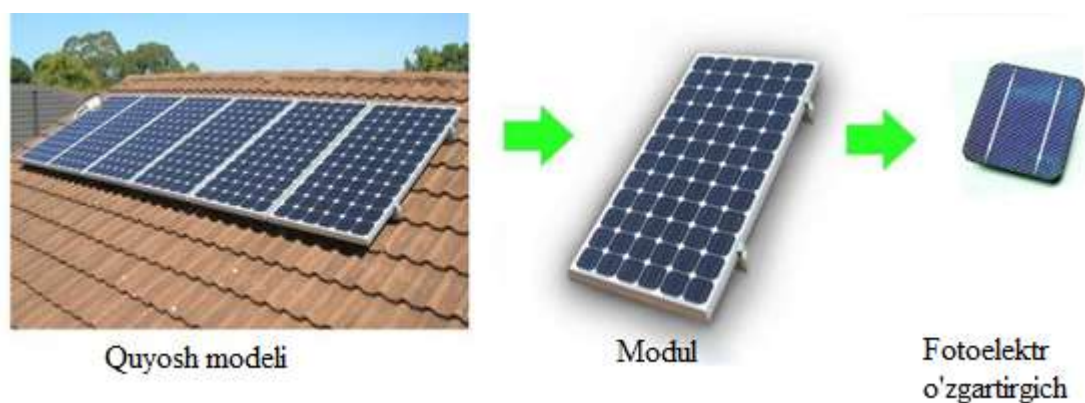
3.2.7-rasm. Fotovoltaik panel qurilishi.
