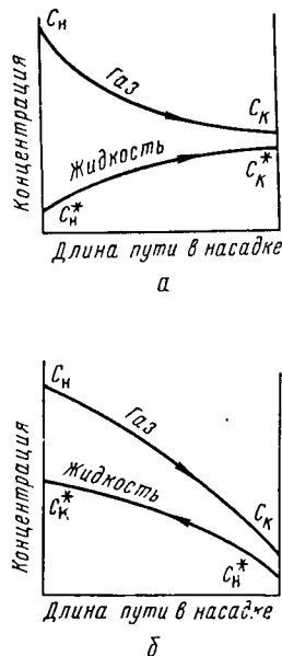
Рис. 2.7. Изменение концентраций при абсорбции компонента газовой смеси жидкостью в башне с насадкой:
