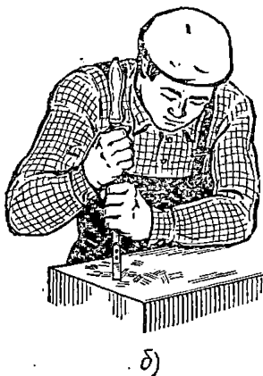
Рис. 238. Шабер для работы способом «на себя» (а) и шабрение «на себя» (б)
