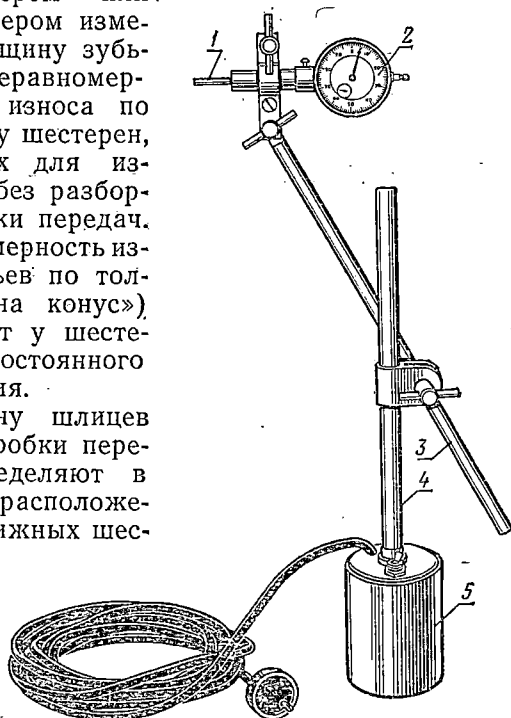
Рис. 84. Приспособление КИ-4850 ГОСНИТИ для проверки зазоров в подшипниках:
