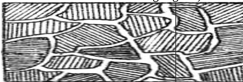
13-rasm. Evtektoiddan keyingi poʻlatning mikrostrukturasi
