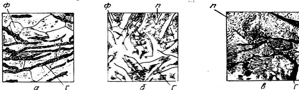
8-rasm. Quyma choʻyanlarning mikrostrukturasi.
