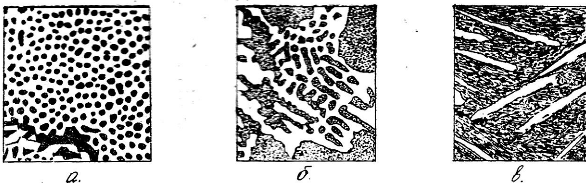
7-rasm. Qayta ishlanadigan choʻyanlarning mikrostrukturasi a ñ ledeburit, b ñ perlit+ledeburit, c ñ sementit+ledeburit
