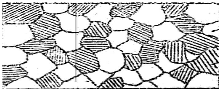
11-rasm. Evtektoidgacha boʻlgan poʻlatning mikrostrukturasi
