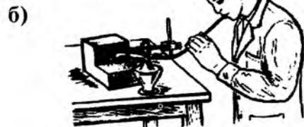
352-расм. Кичик ўлчамли қиздириш лампаси (а) ва ковиялаш қувурчаси (б).
