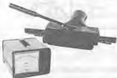
2.30-rasm. DO-1 rusumli dizel dvigatellarning chiqindi gazlarni tezkor nazorat etish tutino'lash asbobi (gaz oqimini yoritish usulida ishlaydi, kuchlanishi 12 va 220 V yoki 24 va 220 V, tashqi o'lchamlari: detektor 555x310x255 mm/3,2 kg, o'lchagich 200x190x150 mm/2,1 kg).
