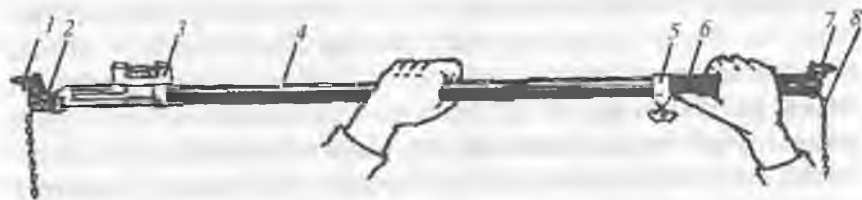
3.46-rasm. Yaqinlashuv burchaklarini sozlash lineykasi shakli.
