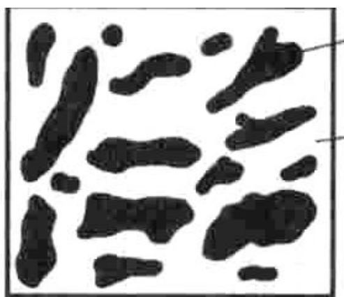
3.11–rasm. Evtektik oq cho‘yan strukturasi
