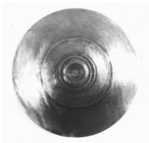
7.14-rasm. Qattiq qotishmaBK6-po‘lat40XHMJI kompozitsiyasiya, matritsa diametri 150 mm,
