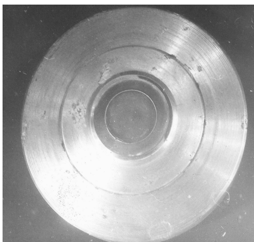
6.6-rasm. Matritsa diametri 184 mm bo‘lgan tezkesar po‘lat P6M5-po‘lat 40XHM kompozitsiyasi
