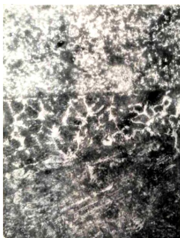
5.3-rasm. Molibden asosidagi qotishma MoTiC-po‘lat stal 40X kompozitsiyasi termik ishlov berilgandan keyingi mikrostrukturasini. O‘tish qatlami materiali Su–Ni asosidagi sim. x100 kattalashtirilgan
