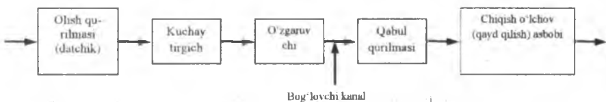
2.55 – rasm. Dozimetrlar ishlash prinsipining umumiy sxemasi
