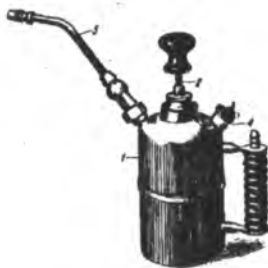
2.52-rasm Pnevmatik dastakli purkagich «Dezinfal» ning umumiy ko‘rinishi: 1- rezervuar, 2- porshen, 3- changlatgich, 4- suyuqlik quyiladigan teshikni bекitib turadigan qalpoqcha
