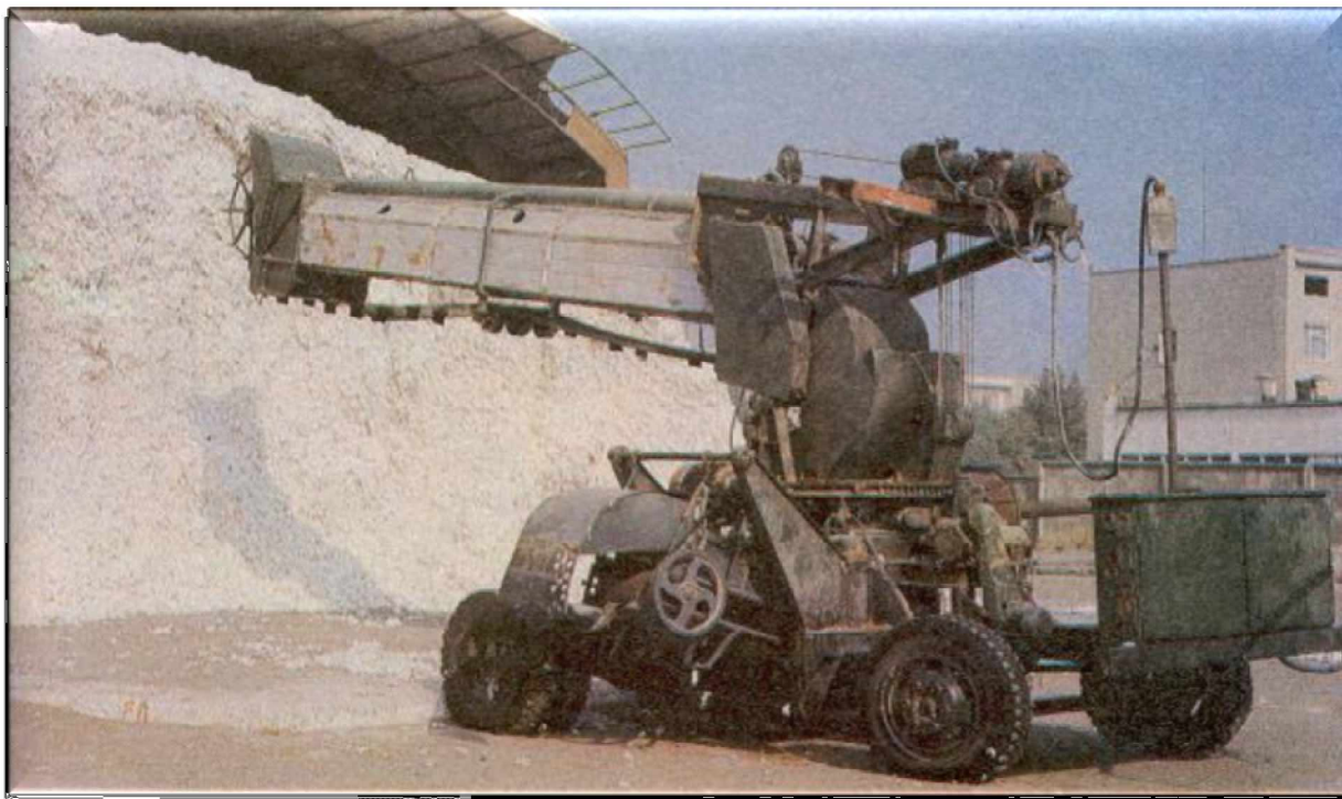
3-rasm. PII- rusumli buzgich-ta'minlagichning lentali konveyer bilan birga umumiy ko'rinishi.
