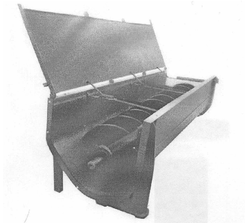
1-rasm. VR-2 turidagi vintli konveyerning umumiy ko‘rinishi.
