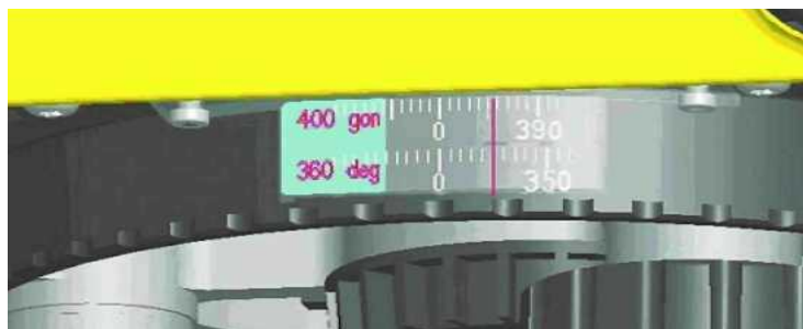
21-шакл. DiNi ёрдамида йўналишларни ўлчаш ва режалаш.
