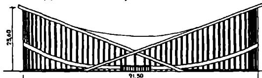
5. Reley shahridagi (AQSh) oval sport zal. Vantsimon po'lat qoplamali konstruksiya.
