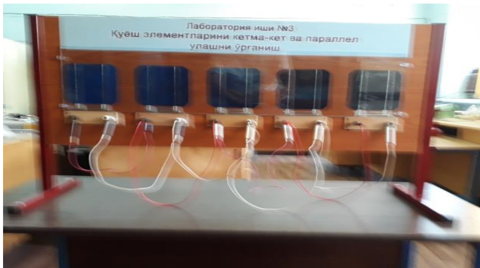
1-rasm. Quyosh elementlarini ketma-ket va parallel ulash uchun tajriba stendi.
