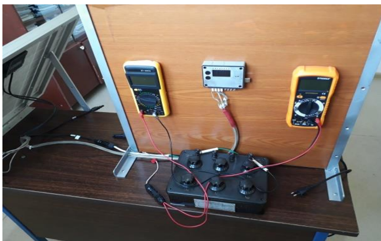
9-rasm. Fotoelektrik batareyaning volt-amper va volt-vatt xarakteristikasini olish stendi.
