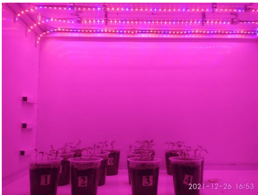
1-расм. Ширин қалампир кўчатларини ўстириш учун мўлжалланган нурлатиш қурилмаси.
