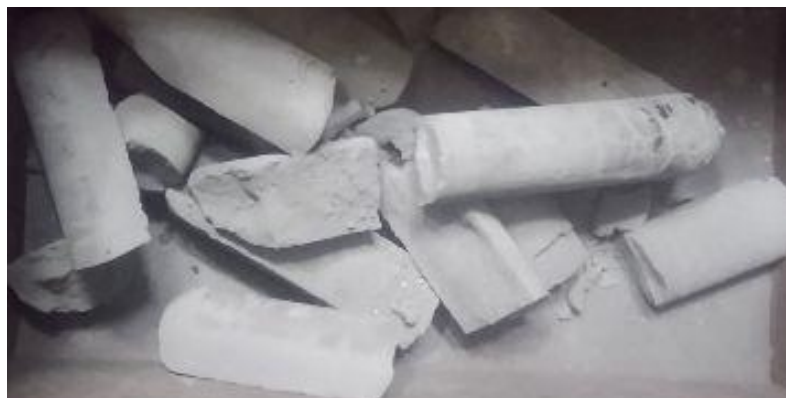
2 – расм. 2200 °C ҳароратда ва 6 соат давомида карбидланган намуналар
