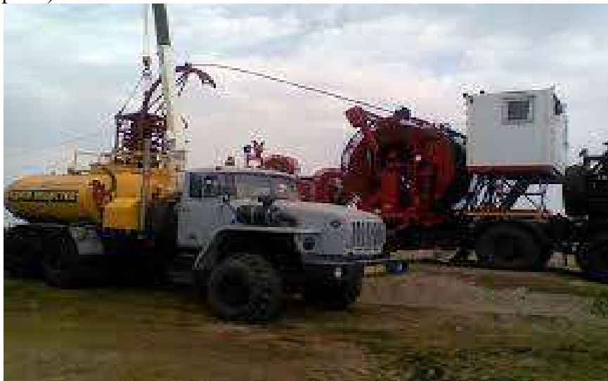
3-расм. Ҳайдовчи қудуқда колтюбинг қурилмаси ёрдамида кислотали ишлов бериш жараёни.
