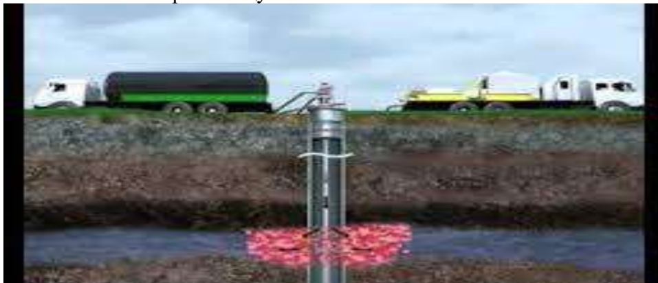
1-расм. Хайдовчи кудуқ орқали сув ҳудудига кислотали ишлов бериш жараёни.
