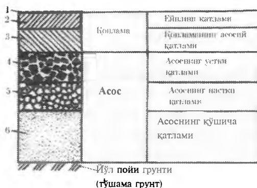
15.2-расм. Йўл тўшамасининг конструктив қатламлари:
