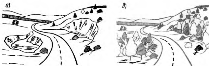
12.6 - расм. Катта яланғоч ёнбағирлар ва қазилган қарьерларни ўсимлик ўтқазиб бекитишнинг турли усуллари.
