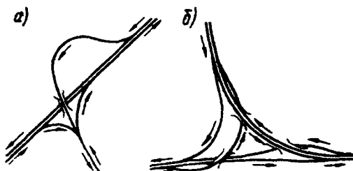
13.17-расм. «Кувур» /а/ ва «учбурчак» /б/ турида қўшилиш схемалари.
