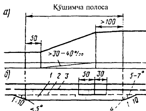
5.7-расм. Кўтарилишдаги қўшимча полосани режалаш схемаси:
