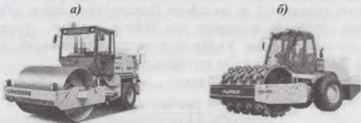
2.10-расм. Ҳозирги замон йўл қатламларини зичлаш катоклари: а) аралаш турдаги виброкаток; б) қовурғали каток.
