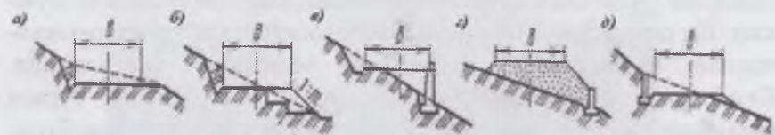
2.47-расм. Йўлнинг тоғ ён бағридаги намунавий кўндаланг кесими.
