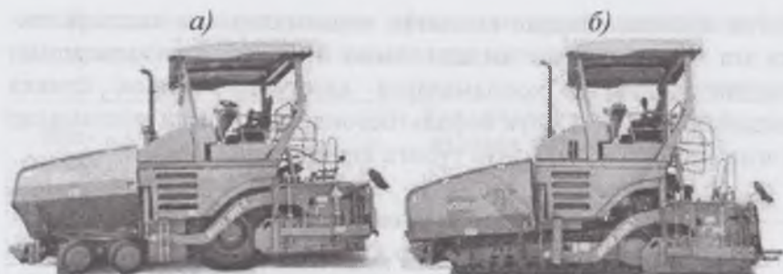
3.12-расм. Ҳозирги замон асфальтбетон қоришмасини йўлга ётқизувчи машиналар: а) резина ғилдиракли; б) гусеничали.
