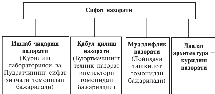
5.1-расм. Қурилиш – монтаж ишларининг сифатини назорат қилиш тизимининг ташкил этувчилари.
