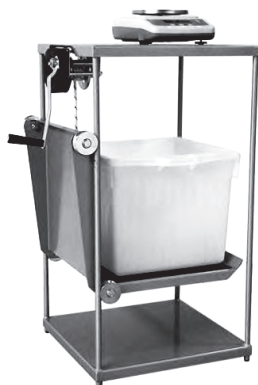
2.7-расм. Чақиқтош (шағал) ни гидростатик тортиш учун фойдаланиладиган техник тарозилар: 1 – тўрсимон (сертешик) стакан; 2 – сув тушадиган найчали идиш; 3 – шайин; 4 – питрали стакан; 5 – қadoқтошлар.
