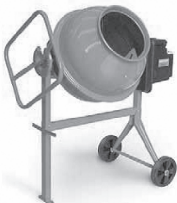
3.1-расм. Лабораторияда қоришма тайёрлаш учун ишлатиладиган барабан типдаги ва цилиндрик идишли бетонқорғичлар.
