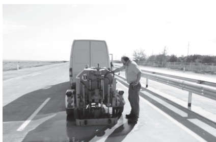
5.6-расм. Қопламадан диаметри 15 см ўлчамдаги цилиндрик керн намунасини бургулаб олиш жараёни.
