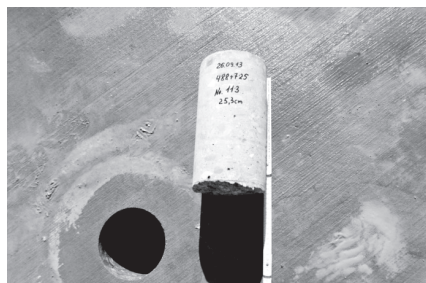
5.6-расм. Қопламадан диаметри 15 см ўлчамдаги цилиндрик керн намунасини бургулаб олиш жараёни.
