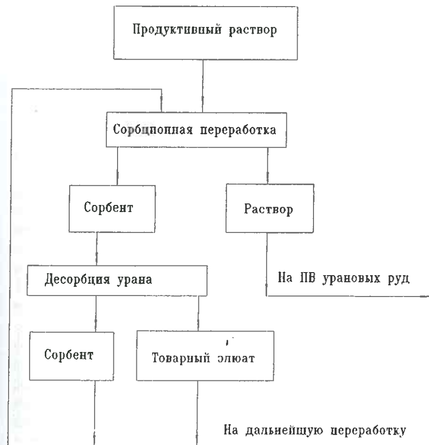
Рис. 1.5.13. Принципиальная технологическая схема сорбционной переработки продуктивных растворов подземного выщелачивания
