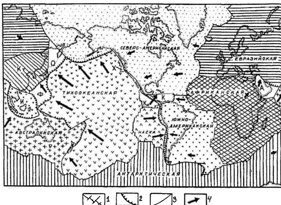
Рис. 3.13. Основные литосферные плиты (по В. Е. Хаину и М. Г. Ломизе). 1 — оси спрединга (дивергентные границы), 2 — зоны субдукции (конвергентные границы), 3 — трансформные разломы, 4 — векторы «абсолютных» движений литосферных плит. Малые плиты: Х — Хуан-де-Фука; Ко — Кокос; К — Карибская; А — Аравийская; Кт — Китайская; И — Индокитайская; О — Охотская; Ф — Филиппинская
