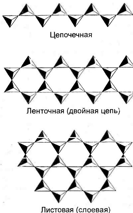
Рис. 2.23. Структуры кремнекислородных тетраэдров, образующих различные силикаты
