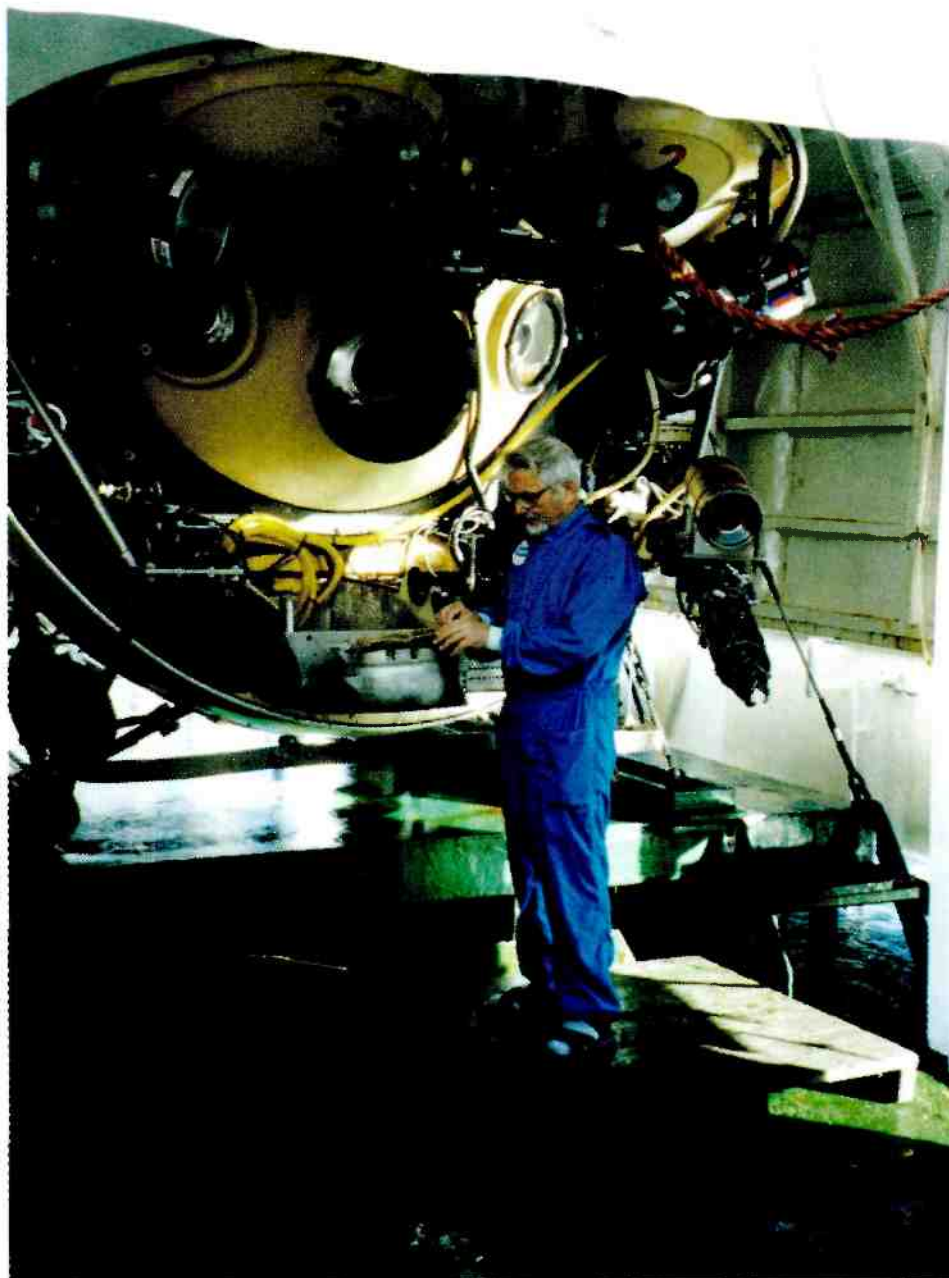
Рис. 19. Подводный аппарат «Мир», способный автономно погружаться на глубину в несколько километров. У аппарата — профессор геологического факультета МГУ, заведующий кафедрой полезных ископаемых В. И. Старостин (фото В. И. Старостина)
