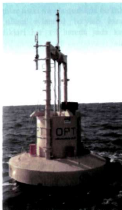
71-rasm. Po'kakli energoqurilmalar.
