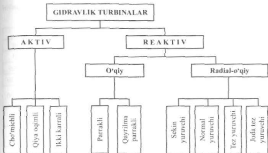
35-rasm. Gidravlik turbinalar klassifikatsiyasi.
