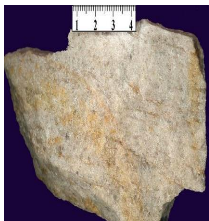
14 rasm. Avantiyurinli kvarstit minerali (A) va uning polyarizatsion mikroskopda olingan rasmi (B):
