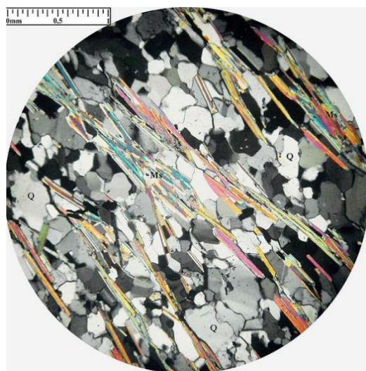
14 rasm. Avantiyurinli kvarstit minerali (A) va uning polyarizatsion mikroskopda olingan rasmi (B):
