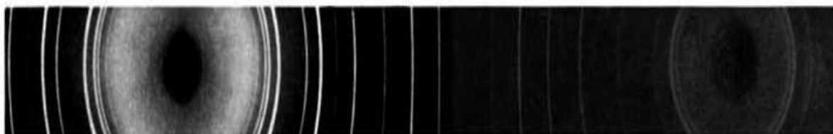
52-rasm. Debyeagramma. Rentgen nurlarini polikristal namunadan o'tkazish orqali olingan. Har bir chiziq namunadagi atomlarning bitta aniq tekisligida rentgen nurlarni diffraksiyasi natijasida hosil boladi.
