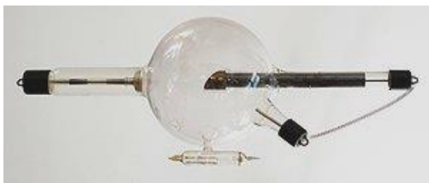
55 rasm. Rentgen trubkalar: A- birinchi rentgen trubka ko'rinishi (1920 y.); B- zamonaviy rentgen trubka ko'rinishi (2020 y.).
