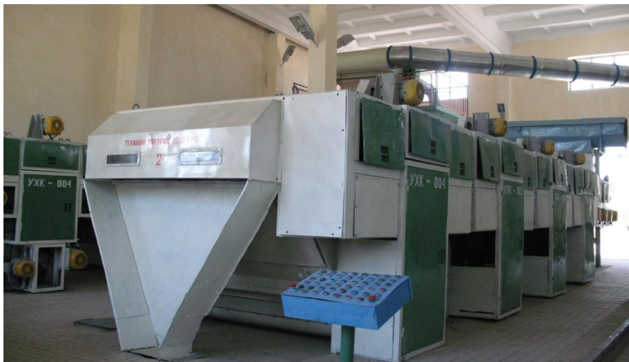
34-rasm.1XK rusumli chigitli paxtadan mayda iflosliklarni toza lash mashina sining umumiy ko'rinishi.
