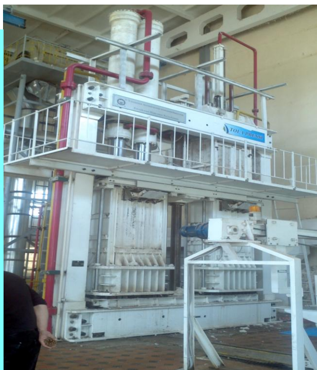
86-rasm. To'liq avtomatlashtirilgan toylovchi pastki eshikli press uskunasi. (Firma: M / s Bajaj Steyel Industriyes Ltd)
