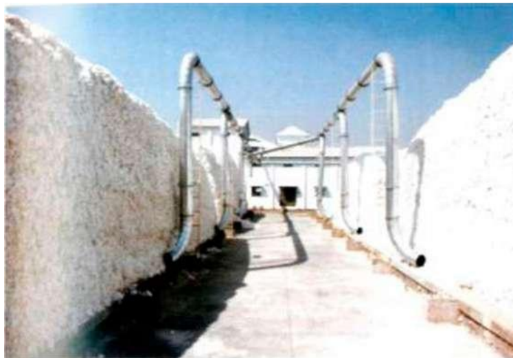
7-rasm. Paxta g'aramidan havoni to'g'ri quvurlar orqali so'rilishi
