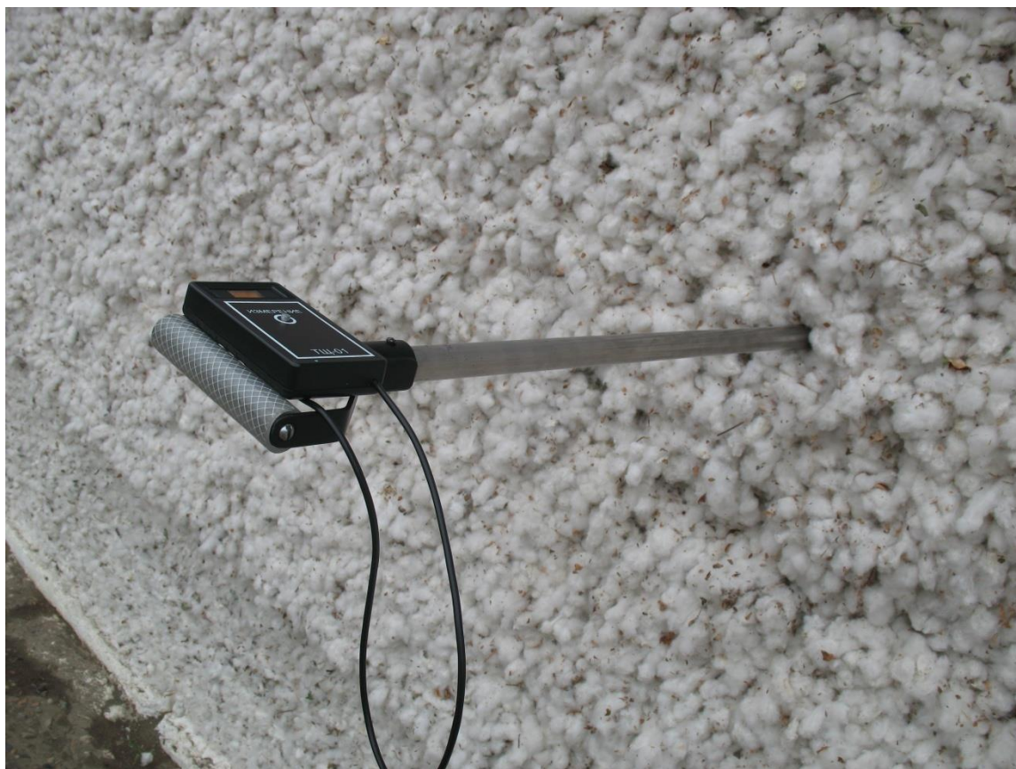
9-расм. ТЩ-01 электрон ҳарорат ўлчагич ёрдамида ғарамдаги сақланаётган пахта хомашёсини ҳароратини ўлчаш
