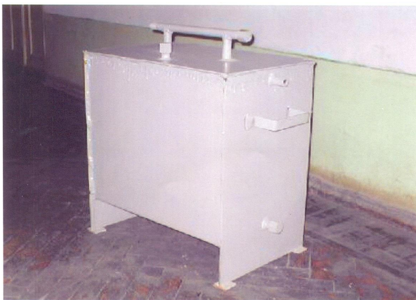
55-расм. Ёқилғини тозалаш учун филтрнинг умумий кўриниши
