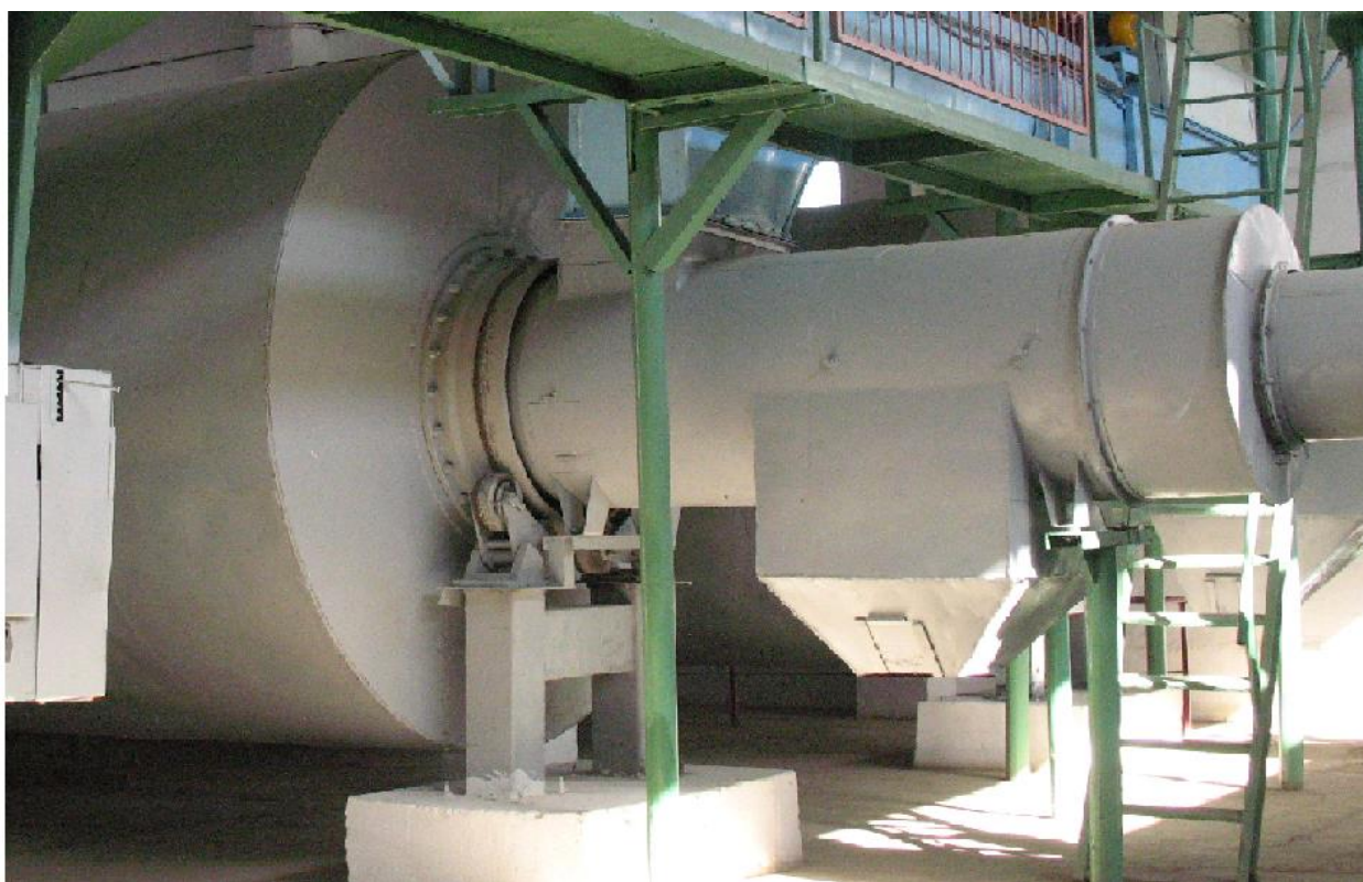
43-расм. 2СБ-10 русумли барабанли қуритгичнинг таъминлагичи, иссиқ ҳаво қузури, барабан, цапфа, барабаннинг олди девори, роликлар ва учқун ушлагичлар кўрсатилган мажмуаси схемаси..
