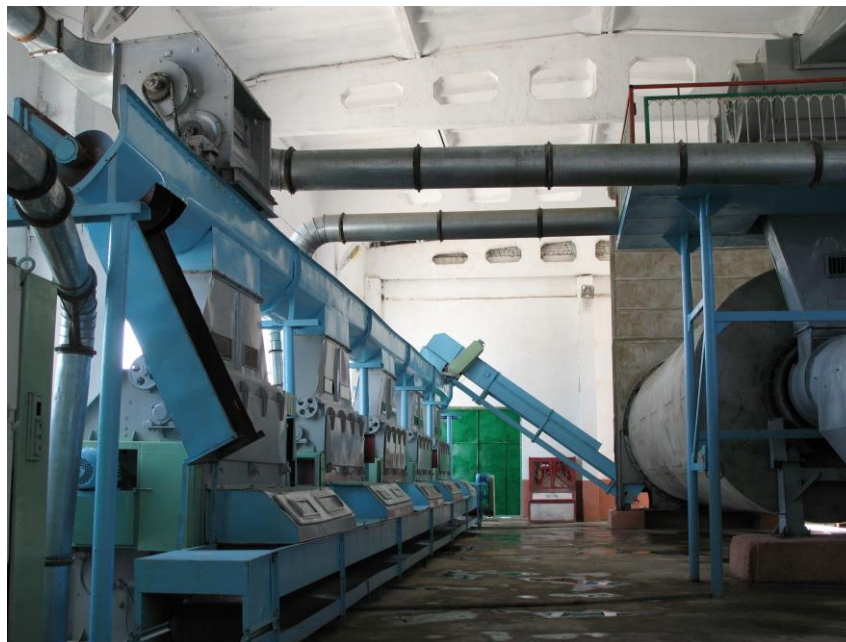
30-расм. 2СБ-10 русумли барабанли қуритгичлар ва пахтани тозалаш ускуналари ўрнатилган ҚТБ нинг умумий кўриниши.
