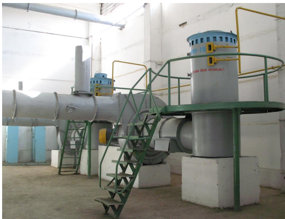
50-расм. ҚТБ даги ўтхонага ўрнатилган ИИЧ-1,9 иссиқлик ишлаб чиқаргичлар мажмуаси.
